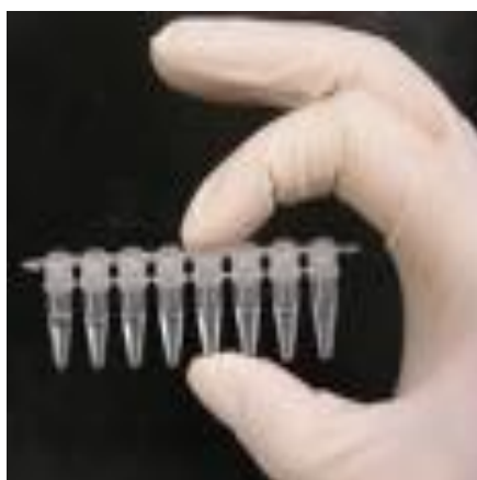
Εικόνα 2. Σωληνάρια PCR καθένα από τα οποία περιέχει 100μl μίγματος αντίδρασης
